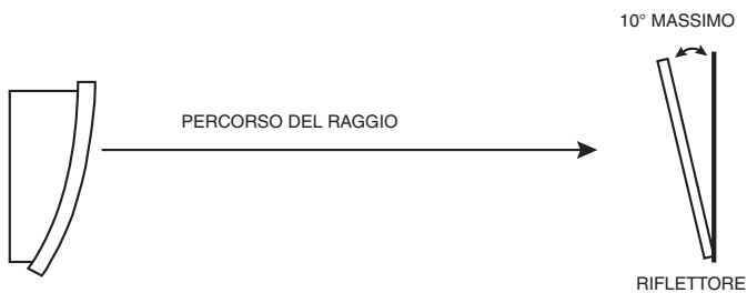
Figura 2b: Montaggio del riflettore, linee guida
