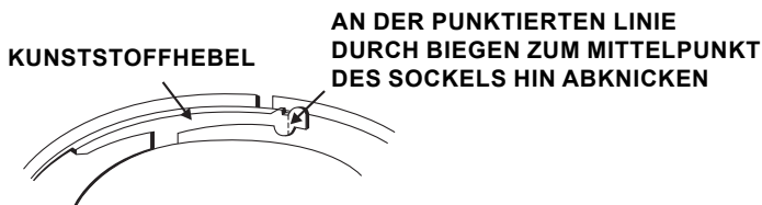
Abbildung 3b: Entfernen des Melders aus dem Meldersockel
