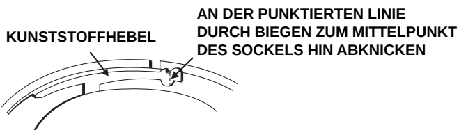
Abbildung 3b: Entfernen des Melders aus dem Meldersockel
